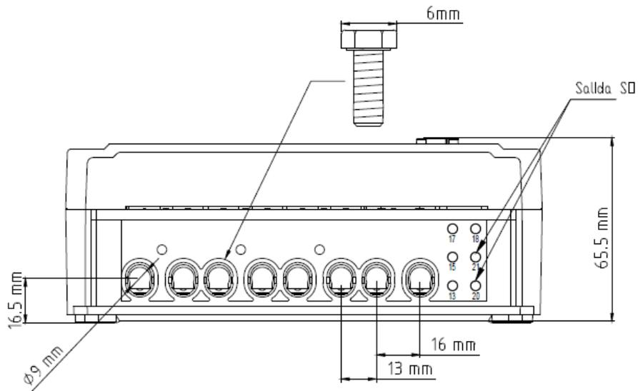
**Nota:** Cada una de las borneras cuenta con 2 tornillos de ajuste para el ingreso de los conductores
